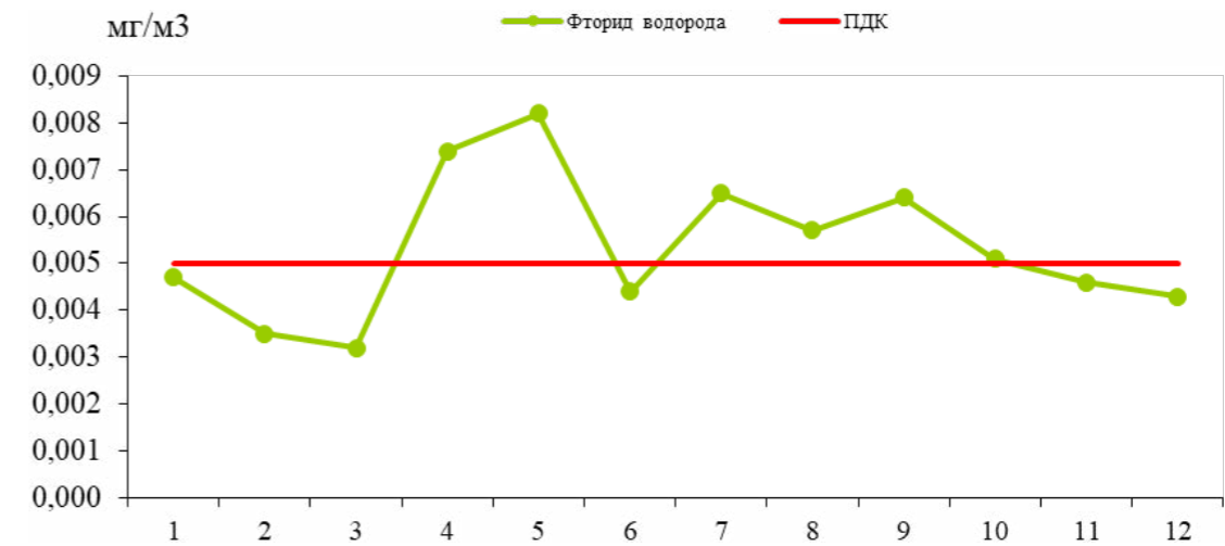
Рис. 2.1.1.4. Годовой ход среднемесячных концентраций фторида водорода в целом по г. Пермь в 2022 г.
